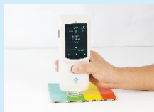
测量较大样品时,只需把仪器测量端口靠近测量样品即可。
